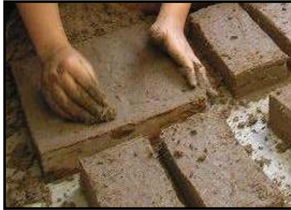
Figura 1- tijolos em terra crua composta de solo e fibra do coco verde
