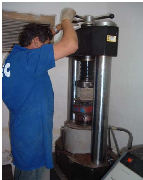
Figura 2 - teste de resistência à compressão simples
