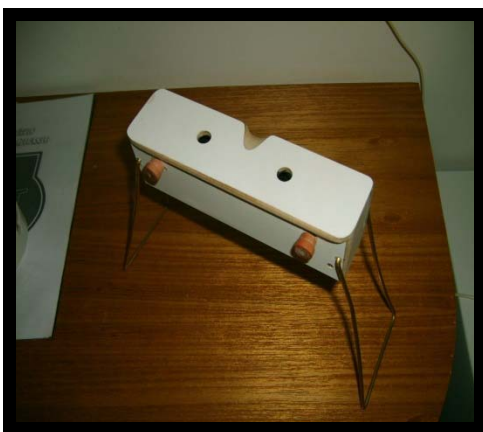
Figura 3: Vista de Cima do Estereoscópio de Espelhos elaborado por Professora na Formação Capão Bonito - SP
