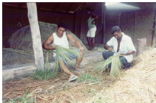
Figura 02: Fase da produção em que a palha é riscada.
