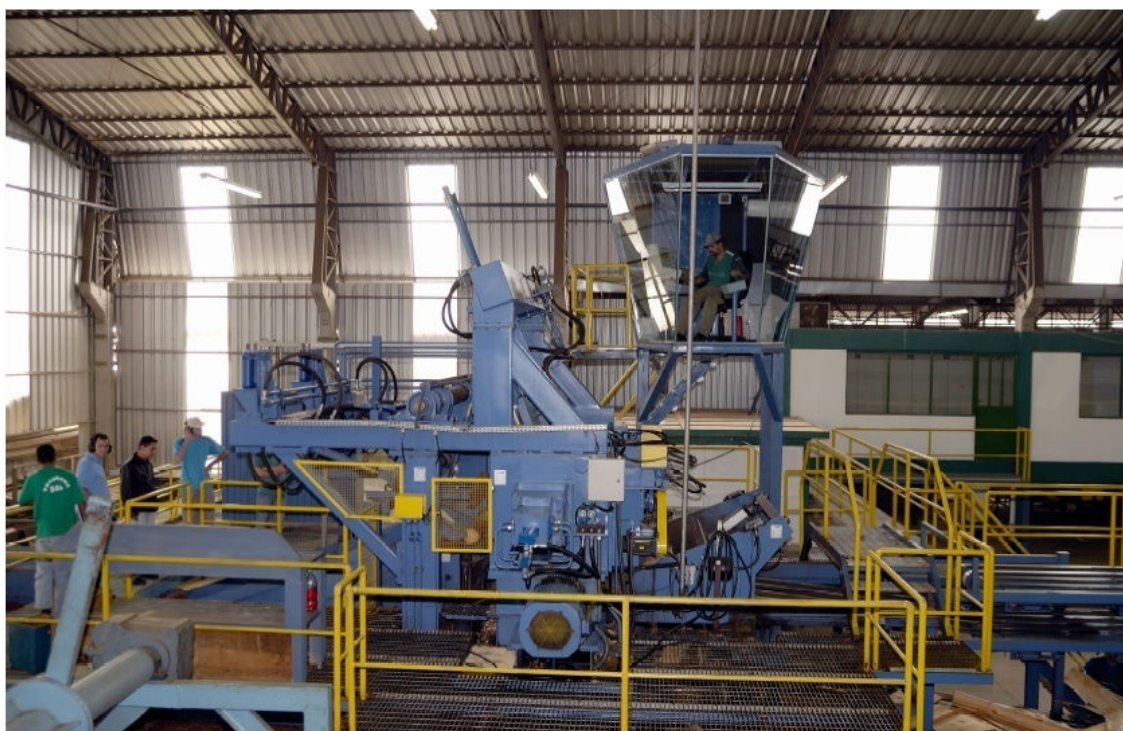
Figura nº 02 - Linha de Torno 4 ft – 12 blocos/minutos
