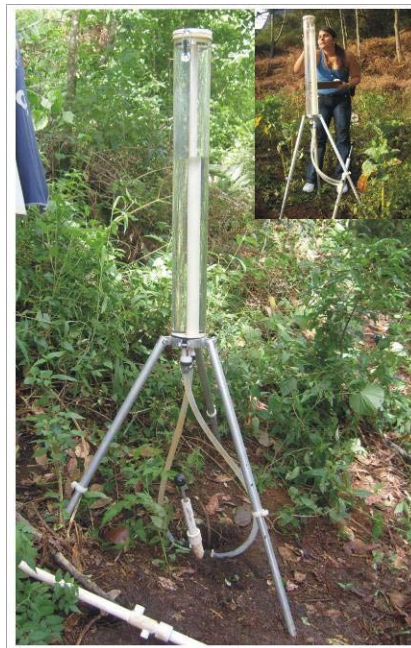
Figura 5: Ensaio de permeabilidade do solo com do Permeômetro IAC (Instituto Agrônômico de Campinas).
