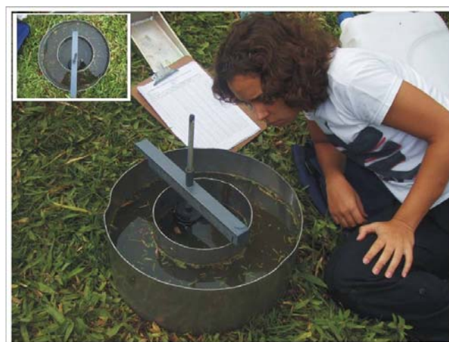
Figura 4: Ensaio de TBI (Taxa Básica de Infiltração), Infiltrômetro de Anel Duplo.
