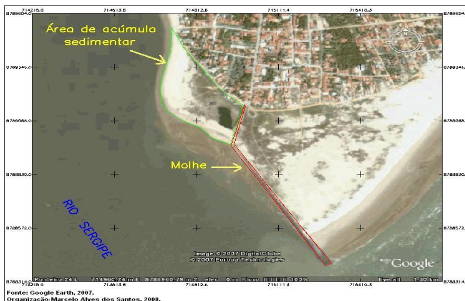
Figura 02: Molhe (primeiro plano) e acumulação sedimentar (segundo plano)-Barra dos Coqueiros.
